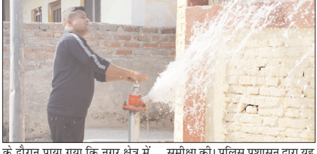
के दौरान पाया गया कि नगर क्षेत्र में स्थापित सभी फायर हाइड्रेंट उच्च कार्य क्षमता के साथ सुचारू रूप से कार्य कर रहे हैं। टीम ने मौके पर ही प्रेशर टेस्टिंग कर उपकरणों की स्थिति का आकलन किया और आवश्यक तत्कीनी पहलुओं की भी
